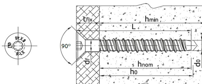
\* Valori riferiti a CLS non fessurato e profondità di infissione standard. La caratterizzazione completa delle proprietà geometriche e meccaniche, nonché della corretta modalità di posa sono contenute nella certificazione ETA.
